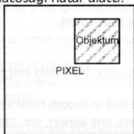
17. ábra: Parciális terület effektus kialakulása. Fent: A leképezni kívánt képlet kisebb a detektor pixelméreténél.
